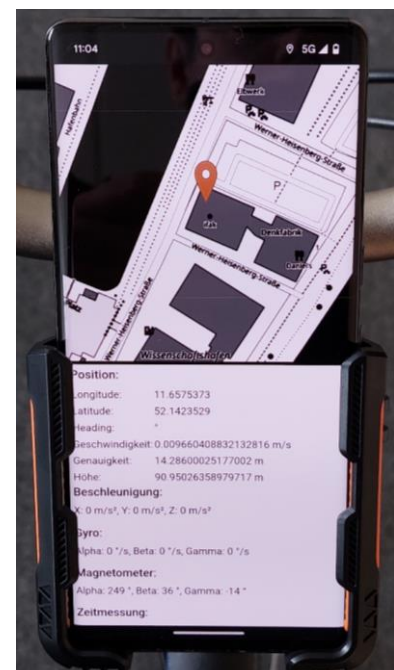
Abb. 27: Experiment zur Untersuchung der GNSS-Ortungsgenauigkeit mit zwei Smartphones
